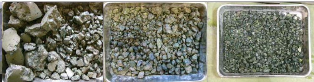
図3 水中パルス放電による破碎過程（左：10回、中：50回、右：100回）
