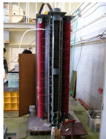
図1 マルクスバンク方式パルスパワー発生器
