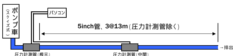
図-2 ポンプ配管状況
