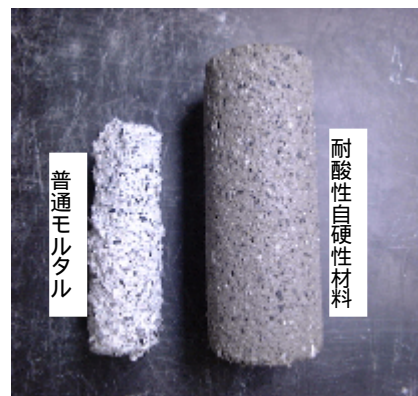
写真 - 1 10wt%硫酸浸漬56日の供試体
