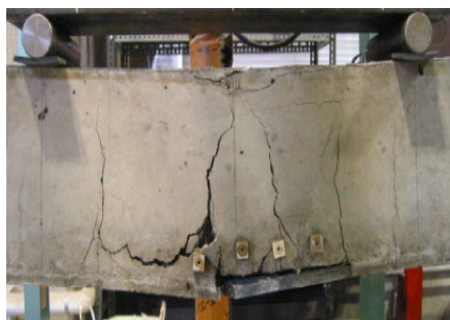
写真-1 UFC 型枠の剥離
