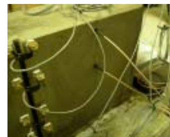
図-6 電気湿度計設置
