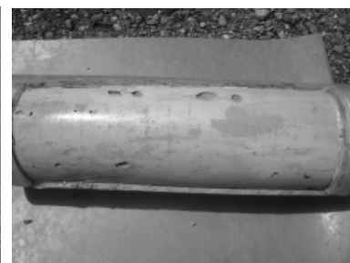
写真-5 グラウト充填状況(透明シース部)
