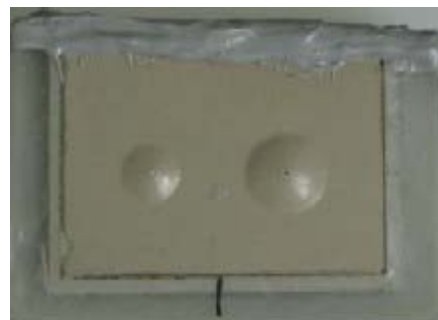
図1 ふくれが生じた供試体(PU-S1,30日)
