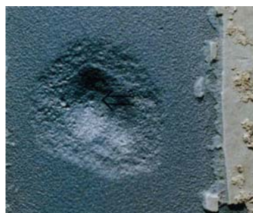
図1. 典型的な塗膜劣化部の鋼材腐食
