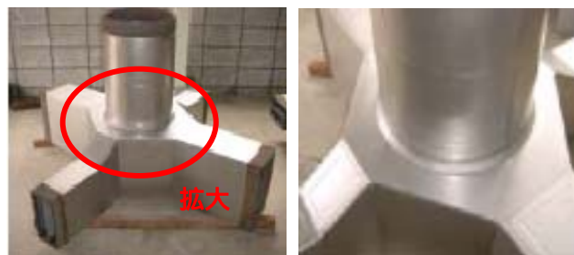
写真-4 極薄金属ライニング施工後
