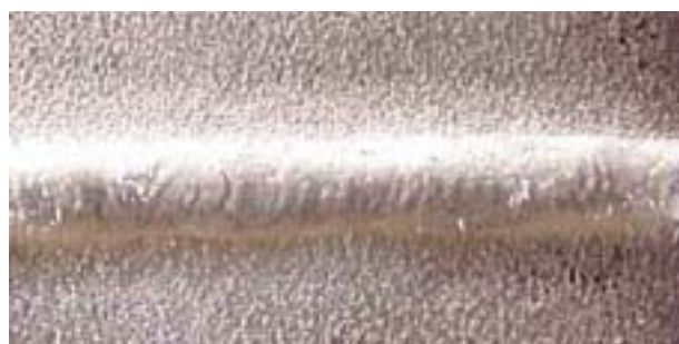
写真-3 腐食状況外観 (HC-4, 電解研磨)
