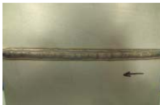
写真-1 TIG 溶接後の外観(HC-4)
