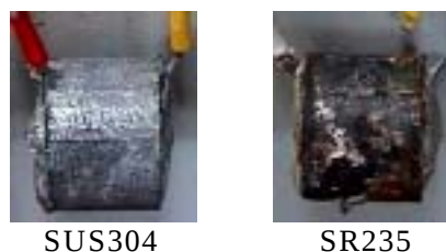
図5 ひび割れ部鋼材の腐食状況
