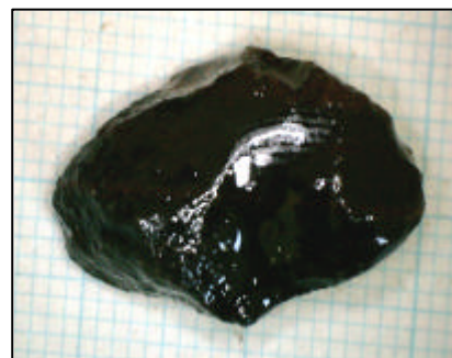
写真-4 被膜後供試体
