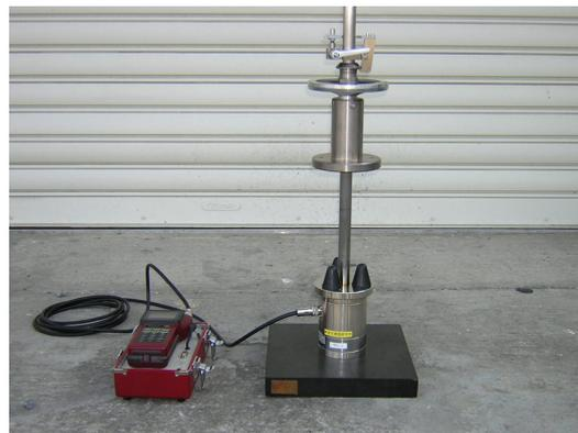
図-1 ゴム板を用いた簡易校正装置の試験状況
