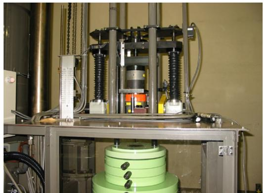
図-4 力基準機による試験状況
