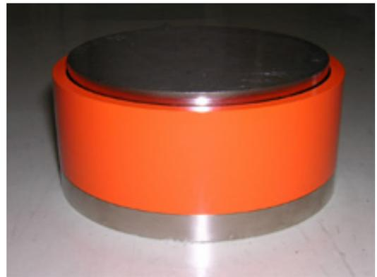
図-3 金属バネを用いた簡易校正装置
