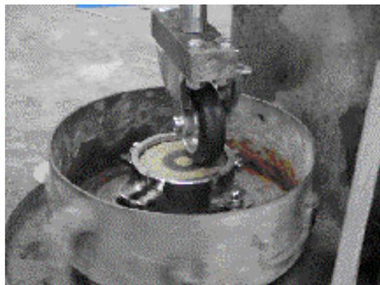
写真-1 簡易据え切り試験装置
