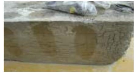
図-3 供試体劣化状況（膨張剤 160kg/m³）
