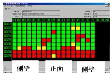
図-1 鉄筋腐食度検査結果
