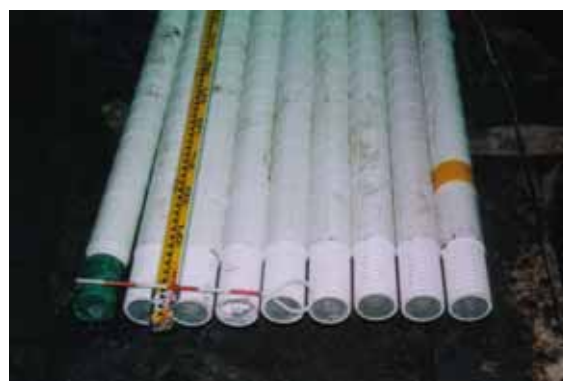
図 - 4 補強材(ガラス繊維強化プラスチック)
