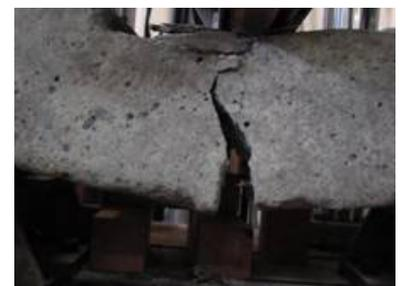
写真2：疲労試験後の3Taの破断状態
