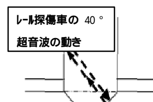
図-3 QPCJの余盛底部付近の様子
