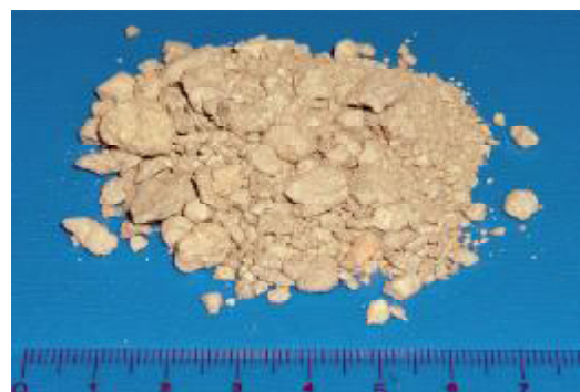
図1 使用したベントナイト Lovell 原鉱 （最大粒径 20mm）
