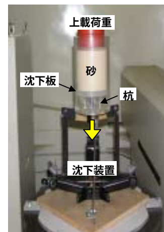
図-3 CT 室内での模型実験装置
