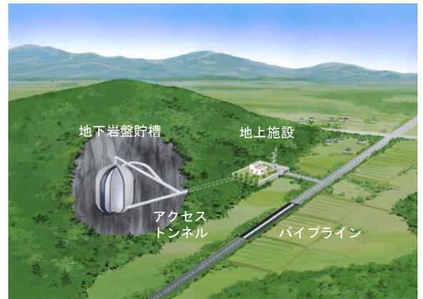
図1 岩盤貯蔵施設のイメージ図
