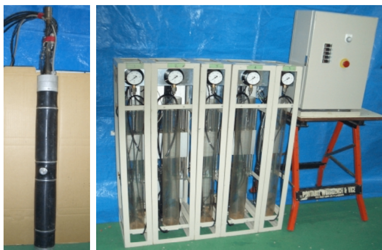
図-1 5連セル型プレッシャメータ試験装置と5連ポンプ
