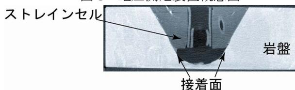
図2 ストレインセル接着状況
