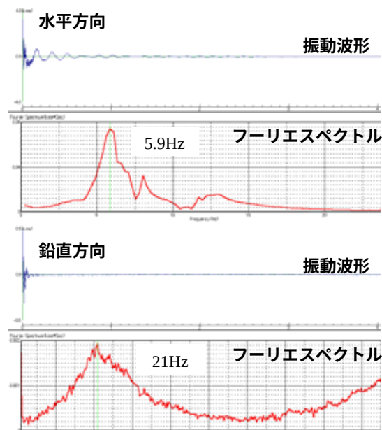
図4 衝撃振動試験結果(間平陸橋 P15)
