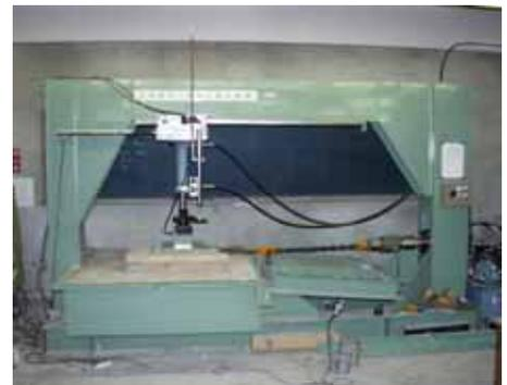
写真-1 室内大型簡易一面せん断試験機
