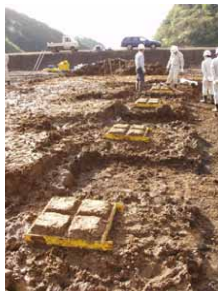
写真 - 1 原位置一面せん断試験の現場状況
