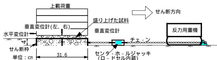
図 - 1 原位置一面せん断試験機の概略
