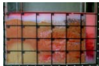
写真3 界面活性剤水溶液注入
