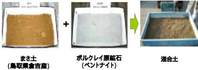
図-2 母材、添加材ならびに混合土の状況
