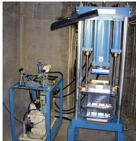
図.1 小型ベントナイトブロック専用プレス成型装置
