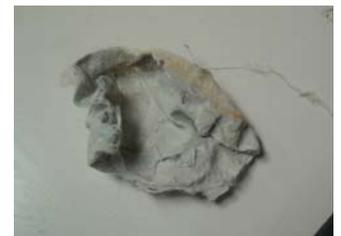
図-7 フィルタ材の目詰まり状況
