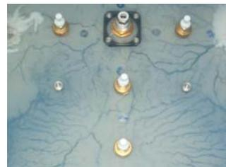
図-6 グラウト材内部に発生する水みちの進展
