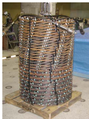
写真-1 鉄筋かご縮小状態
