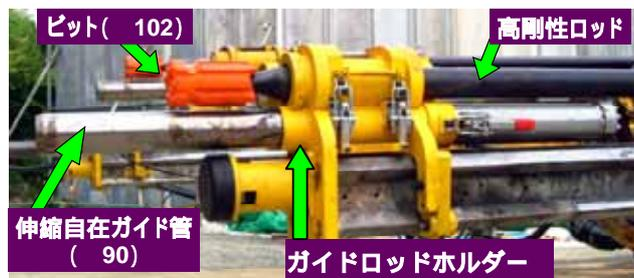
図-1 割岩装置：EG-Slitter
