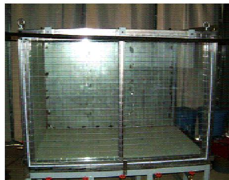
写真-1 試験土槽
