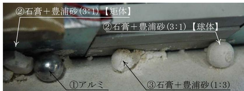
図-6 模型擁壁に衝突した落石の破碎状況
