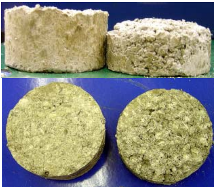
写真－3 締め固め供試体の表面・断面の比較（含水比 20%，1Ec）
