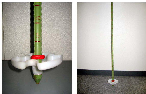
図-1 開発した簡易ヘドロ層厚計測器
