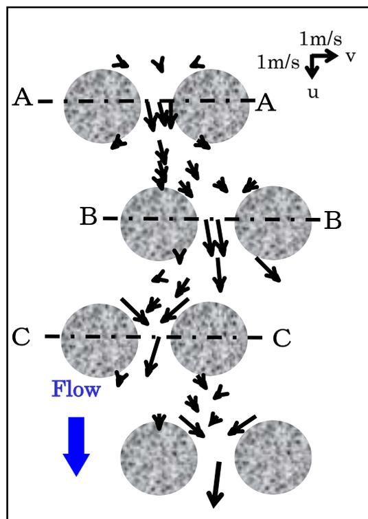
図-3 円柱粗石魚道左岸側における平面流速ベクトル図 (y=1cm)
