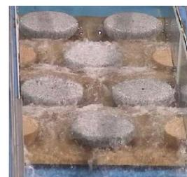
(b)円柱粗石前方で表面渦が形成され隙間を流れる流況( $s/d_c=2.14$ )
