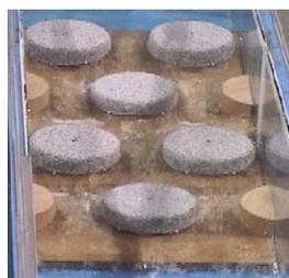
(a)円柱粗石前方で表面渦が形成されず隙間を流れる流況( $s/d_c=2.79$ )
