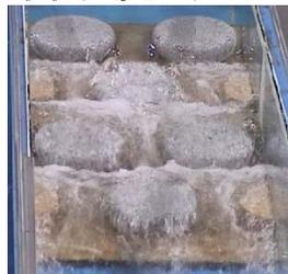
(c)円柱粗石前方で表面渦が形成され粗石上を越流する流況( $s/d_c=1.34$ )
