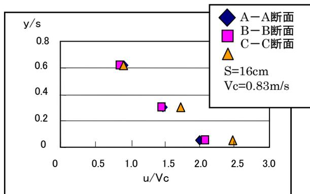
図-4 A-A断面～C-C断面(図-3)における隙間中央部での流下方向の流速分布
