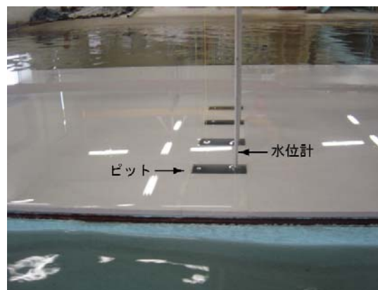
写真-1 水位計の設置状況
