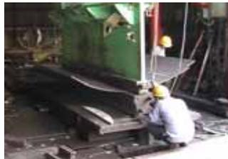
写真 1 鋼板曲げ加工状況
