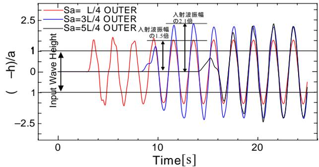
図-3 最大曲率断面外岸の時系列水位変動
