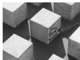
図4 熱流板の設置 (左:1/50スケール(床面)、右:1/5スケール(鉛直壁))
