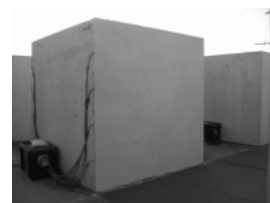
図4 熱流板の設置 (左:1/50スケール(床面)、右:1/5スケール(鉛直壁))
