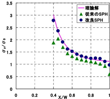
図4 x軸上での無次元化応力分布
