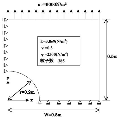
図3 円孔を有する正方形板の4分の1モデル
