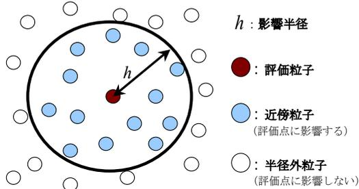
図1 SPH法の概念
