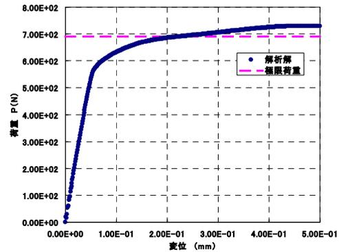
図6 試験片引張解析の荷重－変位関係
