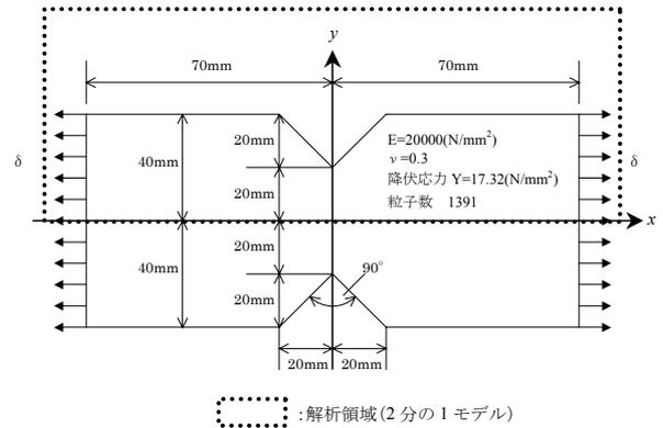
図5 V形切欠きを有する試験片
