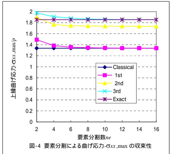
図-4 要素分割による曲げ応力- $\sigma_{xx,max}$  の収束性
