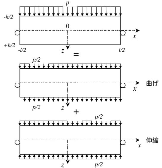
図-1 座標系と梁の曲げ挙動・伸縮挙
