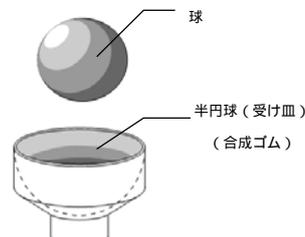
図-1 転動型同調質量ダンパー
