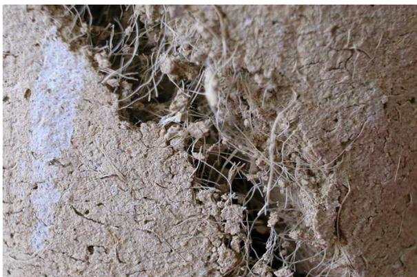
図 - 3 破壊後のジュート補強の供試体のせん断面
