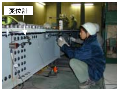
写真-1 プレストレス導入状況
