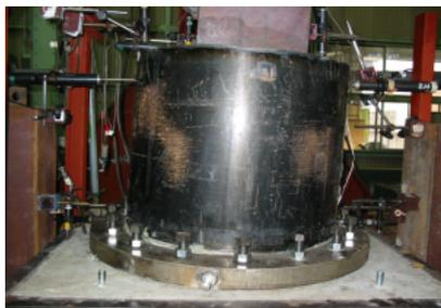
図5 試験体 J0-2 の破壊状況 (変位 110mm)
