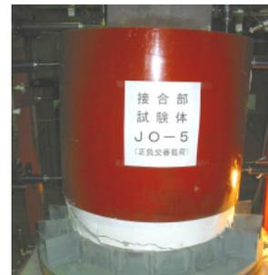
図6 試験体 J0-5 の破壊状況 (変位 110mm)
