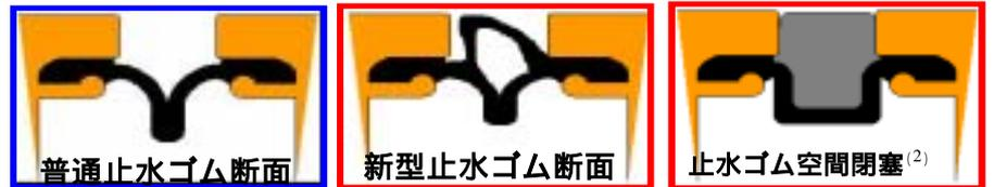
図1 止水ゴム空間における制御策
