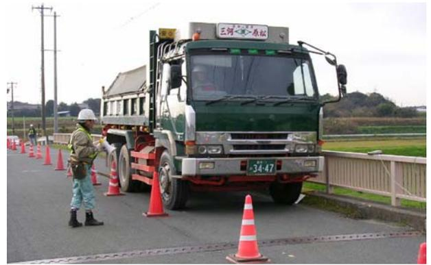
写真-2 静的載荷試験状況 (196kN 荷重車)
