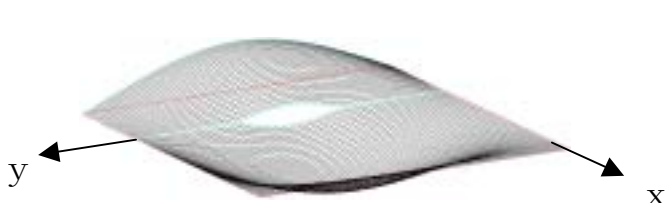
図 2-1 二辺単純他辺固定支持の場合 の1次振動のたわみ曲面
